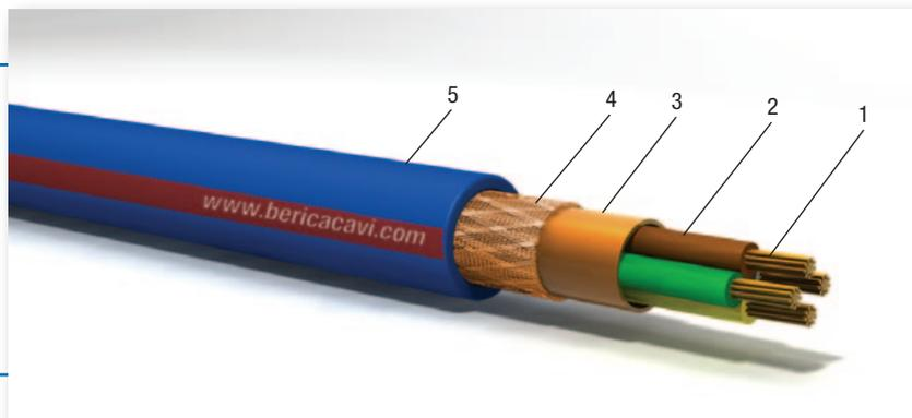
**IMPIEGO:** Adatti alla trasmissione di segnali e comandi per l'interconnessione di strumentazione e sistemi di controllo con trasmissione di segnale digitale od analogica in ambienti esterni, dove è richiesta una maggiore protezione contro le interferenze elettromagnetiche (treccia di rame) ed elettrostatiche (nastro alluminio/poliestere) e contro gli agenti atmosferici ed in particolare i raggi ultravioletti.
